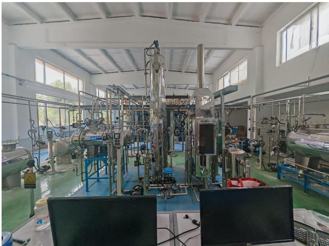
化工仪表 HSE 应急演练系统基于石油、石化和化工行业健康、安全与环境（HSE）管理体系设计开发的实训平台。该系统通过高仿真化工仪表设备、智能控制模块及声光电特效，真实模拟火灾、有毒气体泄漏、爆炸、停水、停电等典型事故场景，为学生提供沉浸式应急演练环境，强化安全操作技能与风险应对能力。通过演练，学生可以直接掌握各类紧急情况下的现场应急处置方法、报警、报告流程、疏散逃生和现场自救互救方法，可以培养学生的团队合作意识和风险意识，训练和考核学生的事故应急处理能力。同时也可作为实训教学及企业员工安全培训，以及职业技能竞赛与考核。
