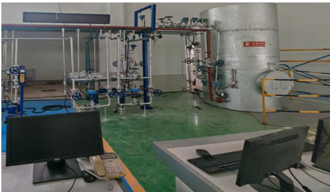
危化品安全生产作业检修操作系统装置是一套高度仿真的综合实训平台，专为化工、石油等涉及危险化学品操作的行业设计。该装置模拟石油化工工艺装置停工检修全流程中模拟设备泄漏、仪表失灵、压力异常等故障现象，学员需通过数据分析与仪器检测定位问题，并执行安全检修程序以及还原危化品生产中的常见作业环节（如管道拆卸、阀门更换、反应釜清理），训练学生按规范流程完成受限空间、高处作业等高风险操作。
