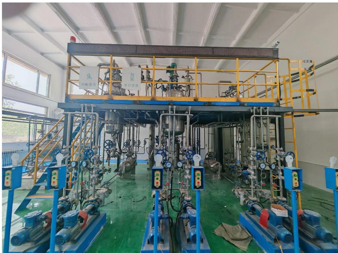
本装置是一套集成化、模块化的危化品生产工艺安全操作实训系统，涵盖石油化工、精细化工、制药、农药、新能源材料等多个领域的典型危化品生产过程化工单元操作（流体输送、传热、精馏、吸收、萃取、反应釜操作等）。典型危化品生产流程（氨合成、氯碱工艺、有机合成、聚合反应、加氢裂化等）。DCS/PLC 控制系统（模拟工业级自动化控制，训练学生掌握工艺参数调节、联锁保护及异常工况处理）。
